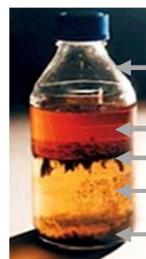
น้ำมันดีเซลในระบบที่สกปรก (Dirty System) มีการปนเปื้อนของจุลินทรีย์ จะมีลักษณะขุ่นมัว
