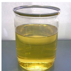
น้ำมันดีเซลในระบบที่สะอาด (Clean System) มีลักษณะใสเป็นมันวาว
