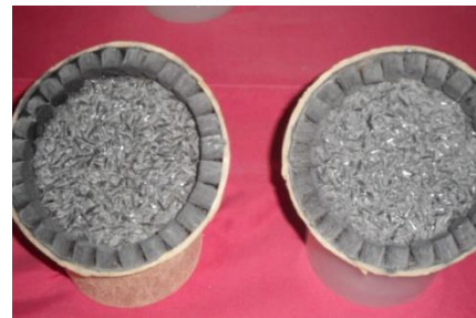
ภาพแสดงการบรรจุเชื้อปะทุระเบิด (Burst charge)
