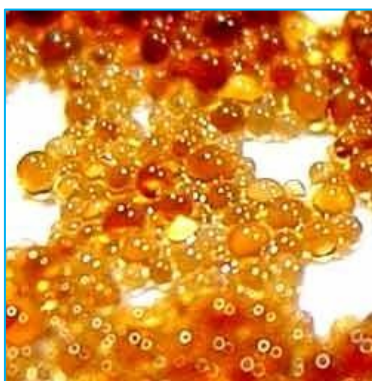
รูปที่ 9 ซ้าย: ลักษณะของเรซินสภาพใหม่ หรือมีความสมบูรณ์ ขวา: การแตกหักและการเสื่อมสภาพของเรซิน
